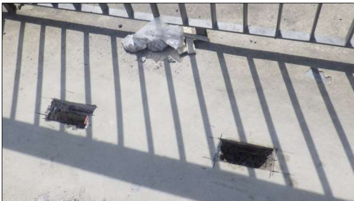
Foto 139: Pohled na otevřené semidestruktivní sondy ke kabelům „systému A“ v levé rýze, zleva - spára 66, prefabrikát 66-67, kabely L 2-3
