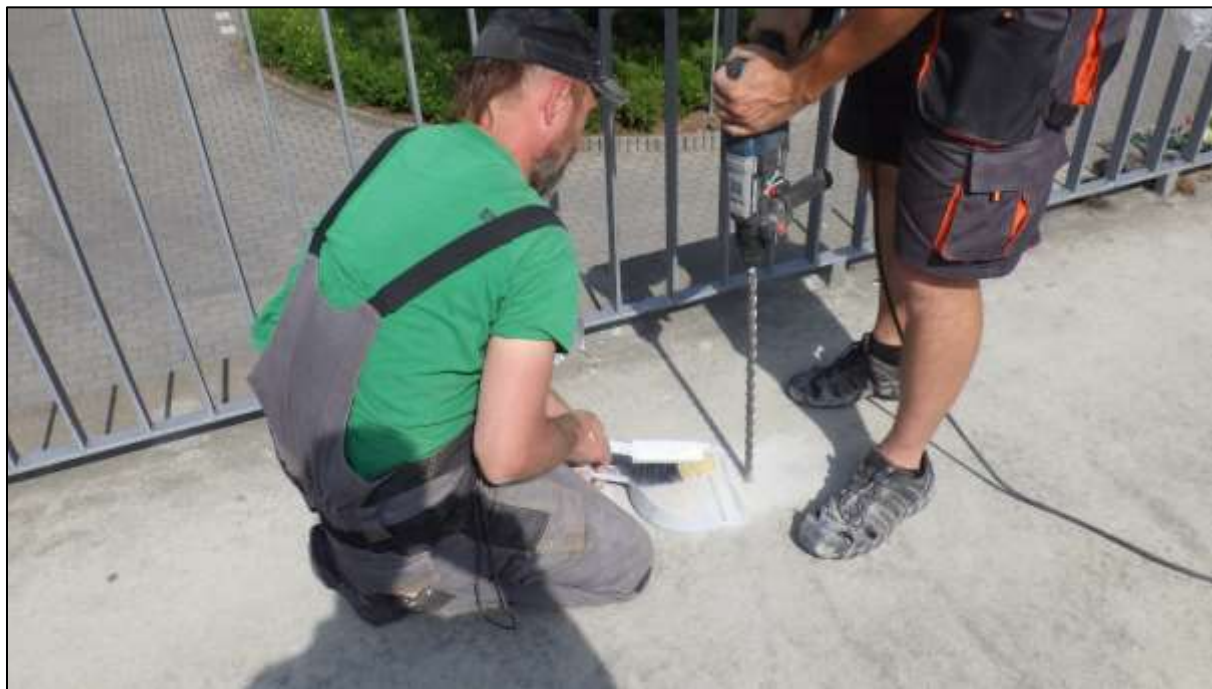
Foto 37: Odběr prachových vzorků na chemickou analýzu betonu
