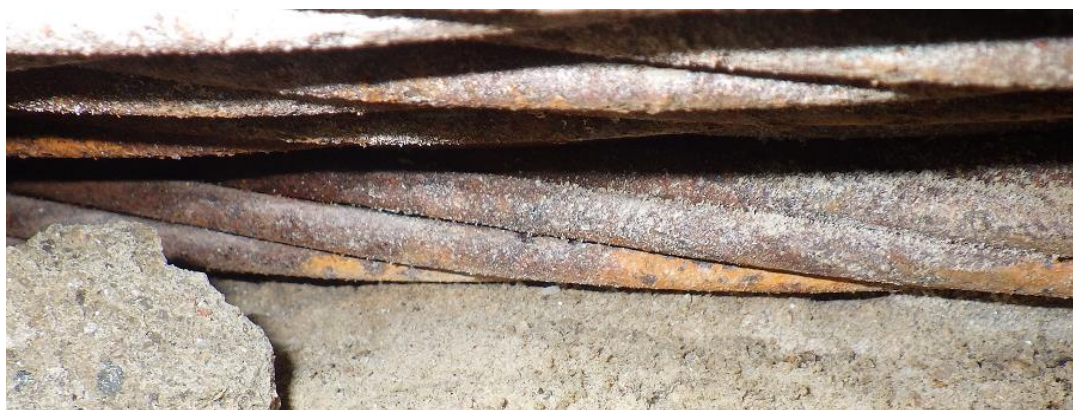
Obr. 2. Vzhled lana s vrstvou pouze povrchově precipitovaných korozních produktů („systém A“, spára 13, kabel P1)
