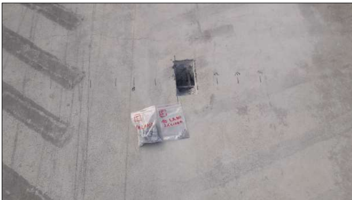
Foto 50: Semidestruktivní sonda ke kabelu „systému B“ v kanálku, prefabrikát 5-6, mezi kanálky 10 a 11, odebraný vzorek betonu a injektáže
