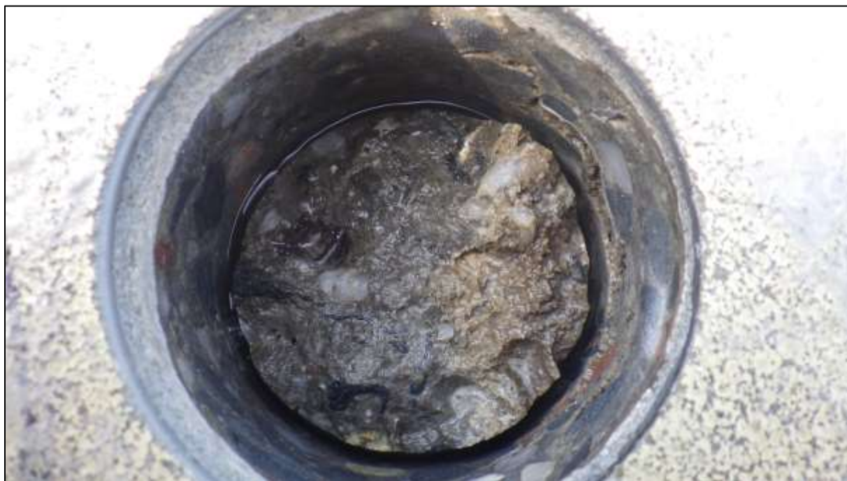
Foto 38: Pohled do vývrtu na rozhraní prefabrikátu (vlevo) a betonu kabelové rýhy (vpravo), zřetelně odlišná barva betonu a dutiny ve výplni rýhy (pravá stěna)
