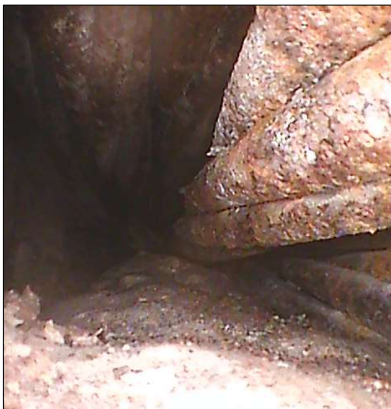
Foto 88: Detailní pohled na lana kabelu P2, patrná koroze patentových drátů, směr spára 1, délka dutiny cca 20 cm od spodní sondy
