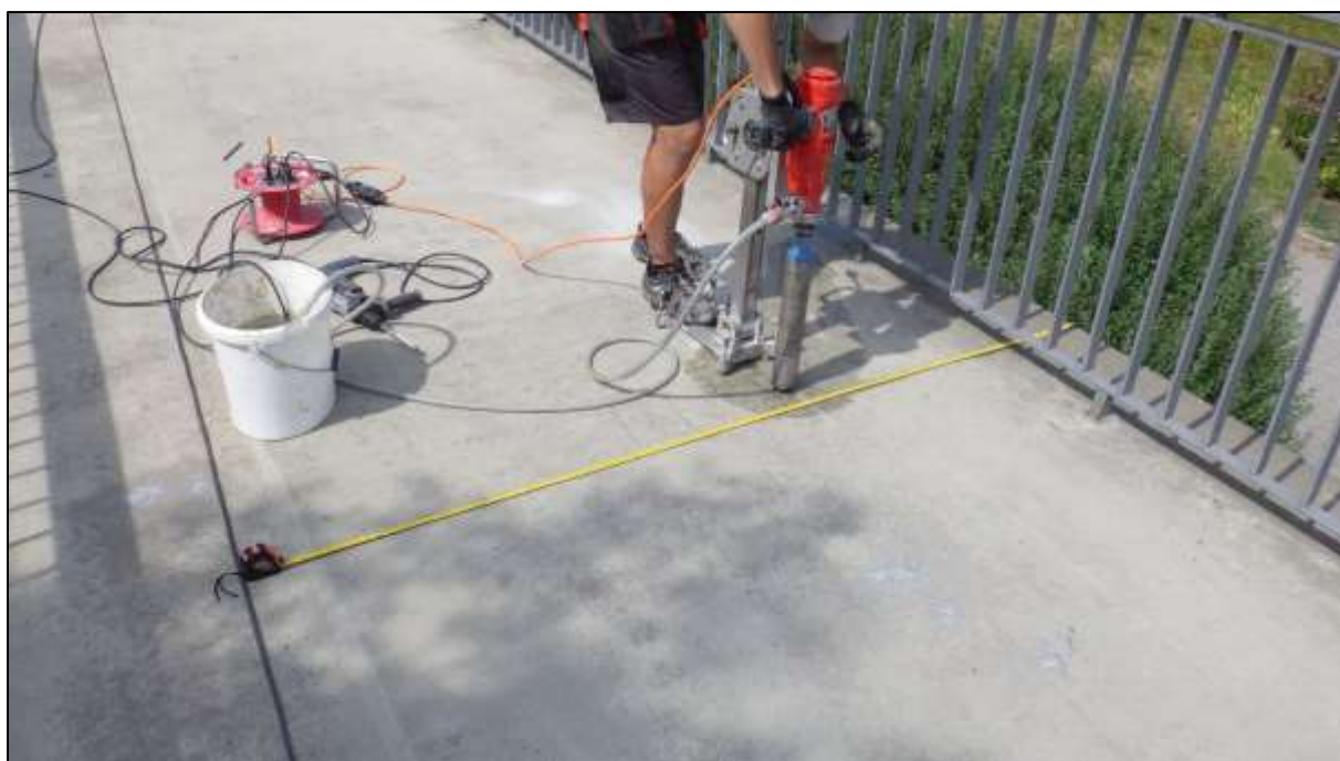
Foto 36: Odběr malých jádrových vývrtů betonu
