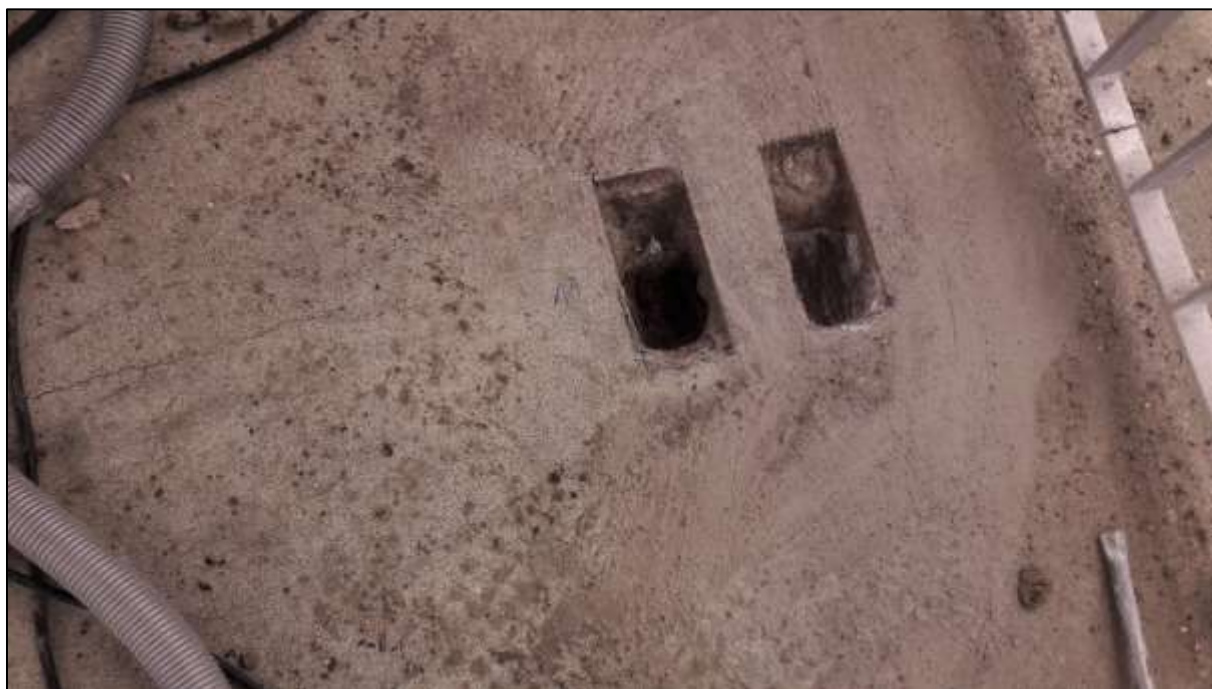
Foto 101: Pohled na otevřenou semidestruktivní sondu ke kabelům „systému A“ v pravé rýze, spára 11, kabel P 1- 2 a 2-3
