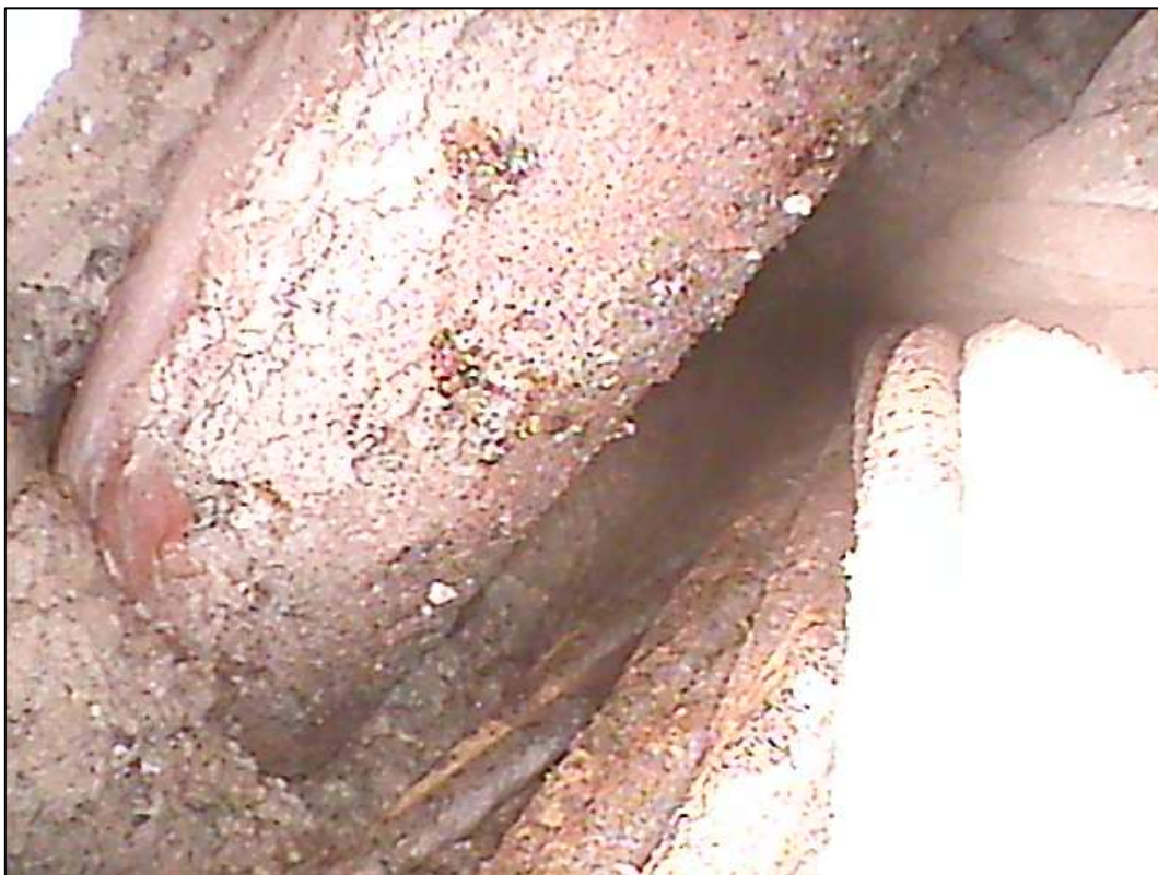
Foto 85: Detailní pohled na lana kabelu P2, patrná koroze patentových drátů, směr spára 1, délka dutiny cca 60 cm od spodní hrany sondy
