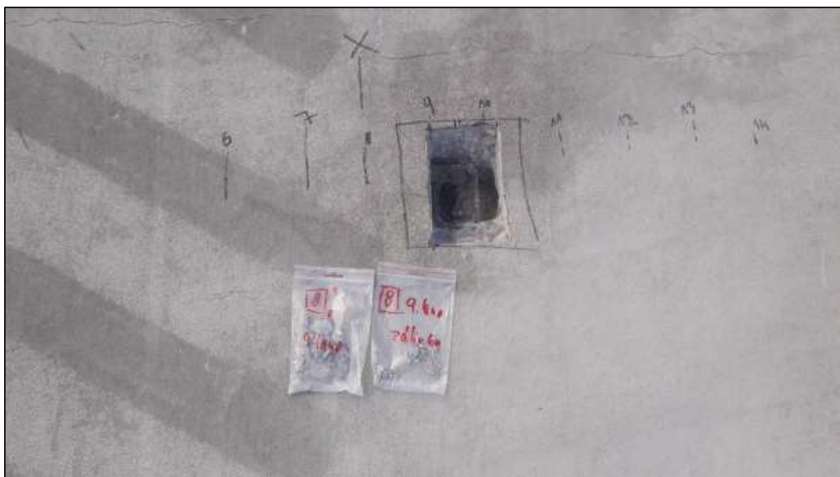
Foto 53: Semidestruktivní sonda ke kabelu „systému B“ v kanálku, prefabrikát 8-9, mezi kanálky 9 a 10, odebraný vzorek betonu a injektáže
