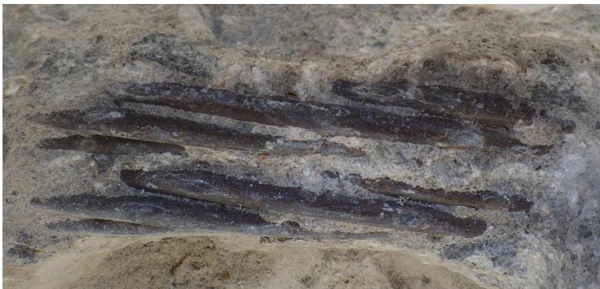
Obr. 1. Vzhled minimálně, převážně povrchově korozně napadeného lana („systém A“, spára 46, kabel L1)
