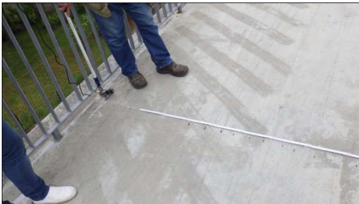
Foto 17: Příklad nedestruktivního měření magnetického pole paralelně pod styčnou spárou prefabrikátů, černě vyznačeny osy předpínacích kabelů, vlevo v rýze „systém A, uprostřed v kanálcích desky „systém B“
