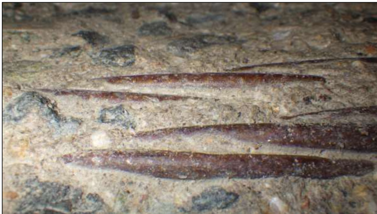
Foto 146: Kontrastní vzhled povrchu patentových drátů předpínacích lan kabelu L 3 po navlhčení, takřka souvislá slabá povrchová koroze, místy tendence ke vzniku důlků
