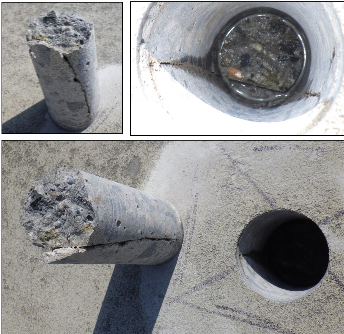
Foto 3: Pohled na vývrt v pracovní spáře prefabrikátu a betonu pravé rýhy, třetí pole (53-54), zřetelně rozsáhlé oddělení trhlinou
