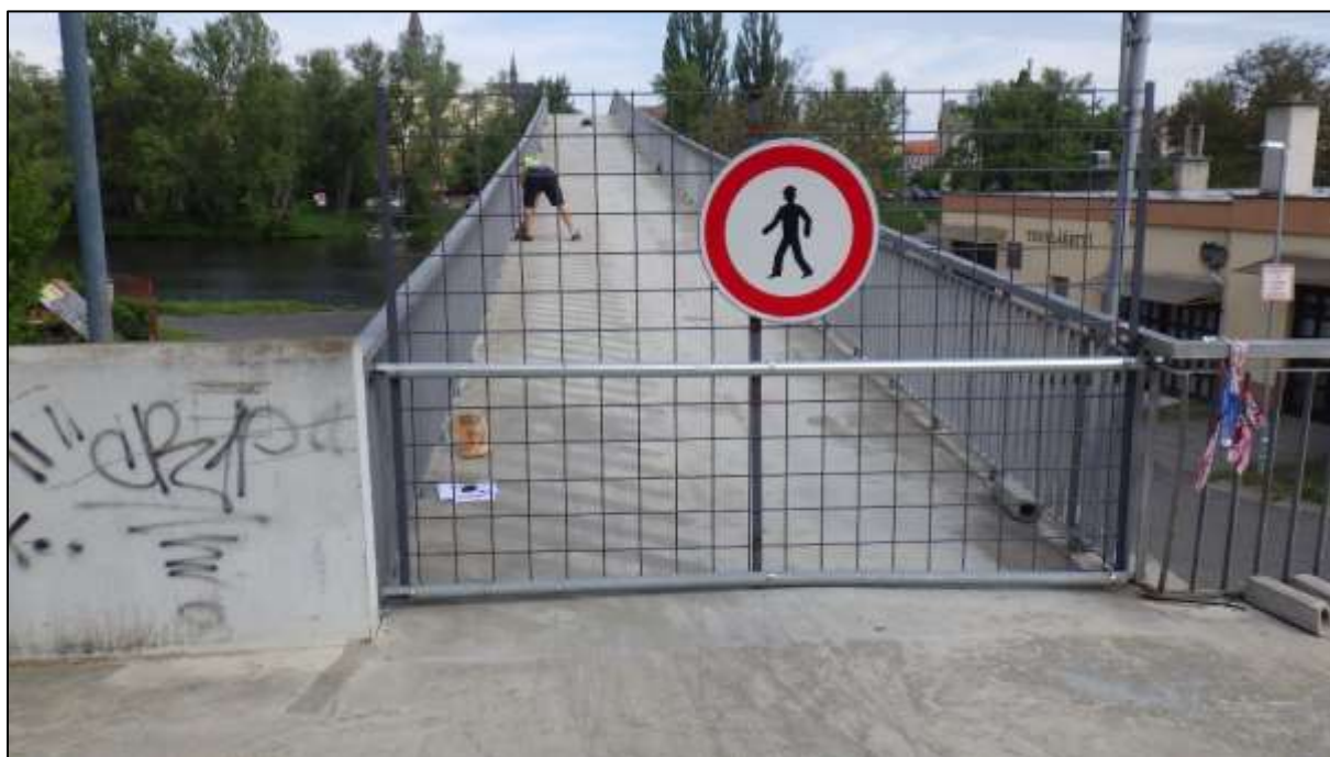
Foto 3: Uzavřený vstup na lávky ze strany Zálabí, provádění nedestruktivní diagnostiky ocelové výztuže přístrojem HILTI 1000
