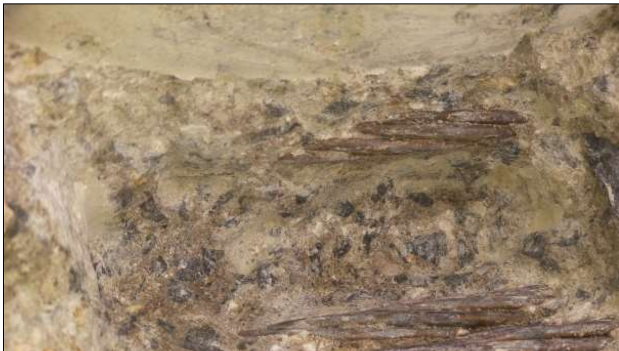
Foto 94: Bližší pohled na korozní stav odkrytých předpínacích lan kabelů P 1 a 2
