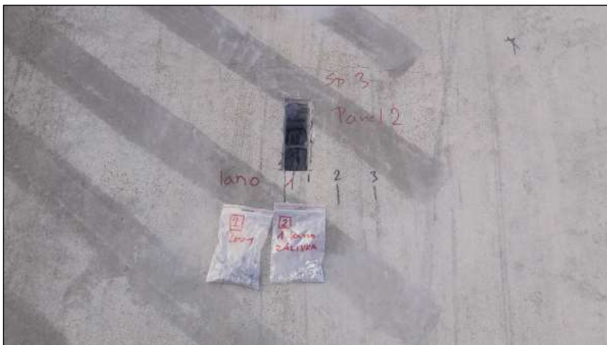
Foto 44: Semidestruktivní sonda ke kabelu „systému B“ v kanálku, prefabrikát 2-3, kanálek 1, odebraný vzorek betonu a injektáže
